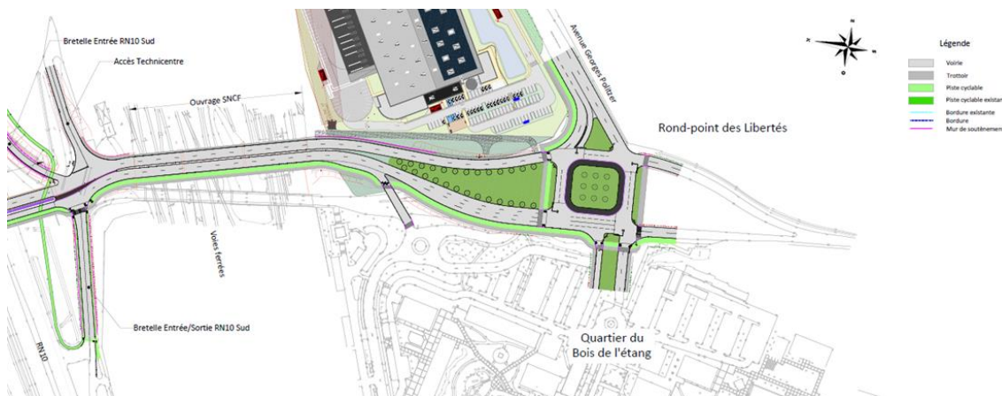
Figure 16 Caractéristiques du projet de doublement des ponts de la Villedieu- section sud de la RN10 – schéma de principe (source : Département des Yvelines, mars 2024)
