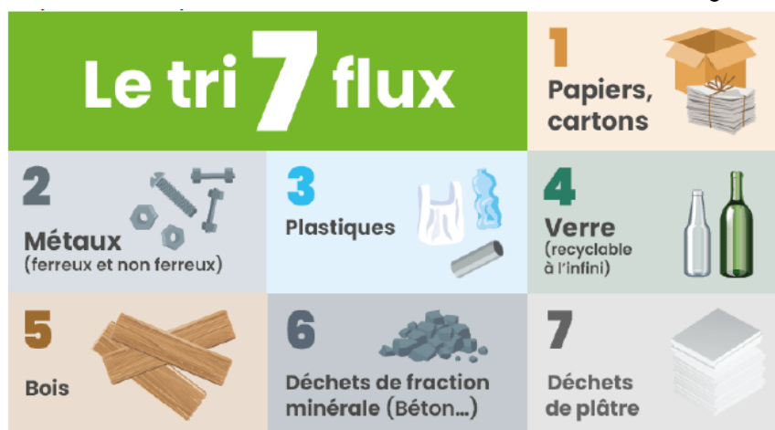
Catégories de déchets à trier lors de la phase chantier
