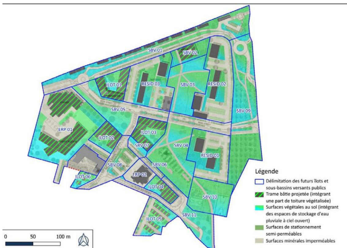
Figure 26 Types de surfaces considérés à l'état projet sur le quartier du Bois de l'Etang (INGETEC, 2024)
