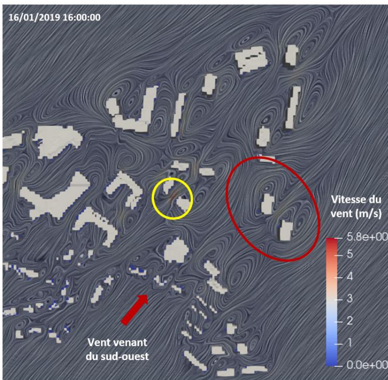
Figure 132 Lignes de courant pour un vent venant du sud-ouest – situation avec projet (ARIA, 2024)
