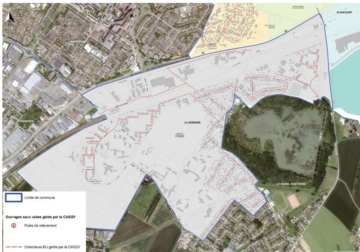
Figure 57 Plan des réseaux d'assainissement des eaux usées au droit de La Verrière (PLUi SQY)
