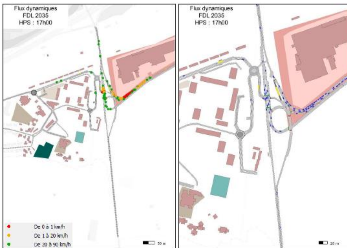
Figure 218 : conditions de circulation à l'HPS Fil de l'Eau SC1
