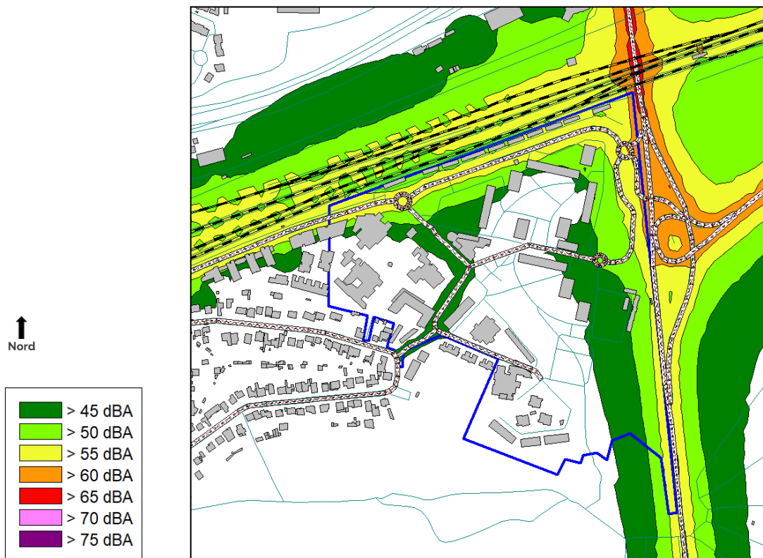
Figure 224 : Cartographie sonore en dBA à 4m au-dessus du sol – Etat Futur sans projet – Période 22h-6h
