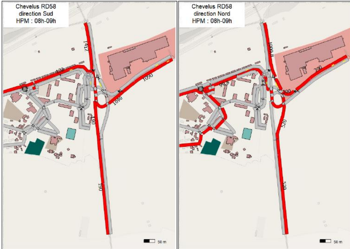
Figure 171 : Chevelus RD58 en direction du Sud et du Nord en HPM (Source : IRIS Conseil, 2024)
