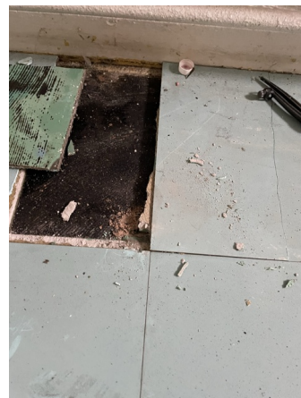
Prélèvement - P7 : RDC / Salle de réunion - Dalle de sol, Colle- (Absence d'amiante)
