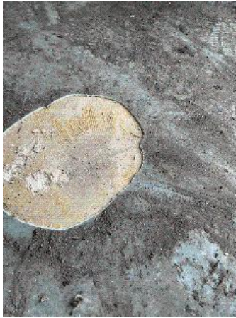
Prélèvement - P16 : RDC / Couloir 1 - Lé plastique, Colle- (Absence d'amiante)
