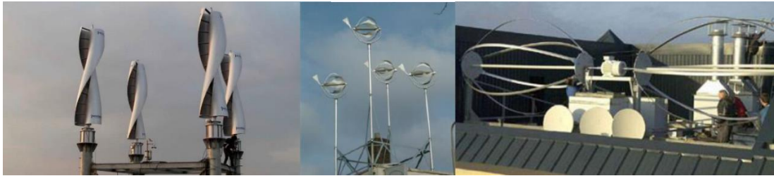
Figure 19 : Eoliennes urbaines de type Savonius (à gauche), Venturi (au milieu) et Darrieus (à droite)
