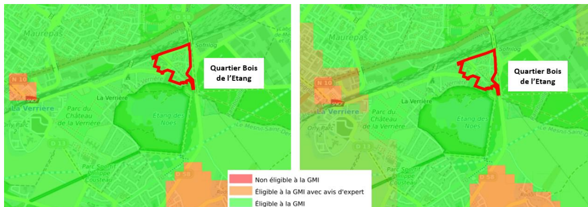
Figure 31 : Eligibilité à la GMI pour les systèmes ouverts (à gauche) et fermés (à droite) pour des profondeurs de 10 à 200m 18
