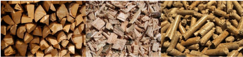
Figure 20 : Bois sous forme de buches (à gauche), de plaquettes (au milieu) et de granulés (à droite)
