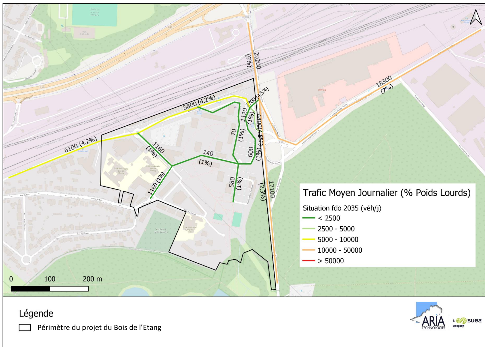
Figure 8 : trafic moyen journalier pour la situation « fil de l'eau » - horizon 2035 (Source : CDVia)
