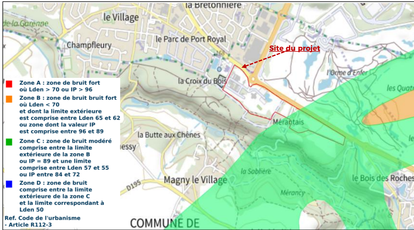
Figure 50 : Localisation du site par rapport aux zones du Plan d'Exposition au Bruit (PEB) de l'aéroport de Paris-Saclay-Versailles
