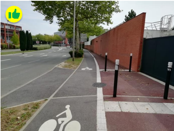
Guyancourt : piste unidirectionnelle, séparée du cheminement piéton par une bande rugueuse et de la chaussée par un terre-plein ; priorité vélo aux entrées/sorties
