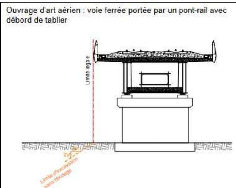
**Exemple 3 : matérialisation de la limite d'excavation, de terrassement et de fondation sans blindage à partir de l'emprise de la voie ferrée pour l'installation radio.**
