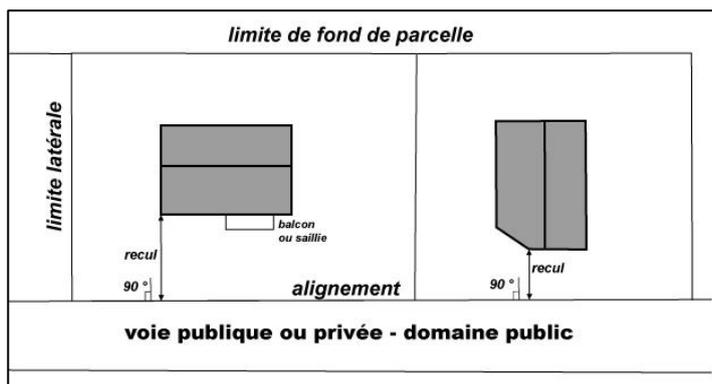
Le recul\* est la distance séparant une construction\* des emprises publiques ou des voies\* (publiques ou privées) ou d'un emplacement réservé. Il se mesure horizontalement et perpendiculairement à la limite d'emprise publique\*, de voie\* publique ou privée ou d'emplacement réservé en tout point de la construction\*.
