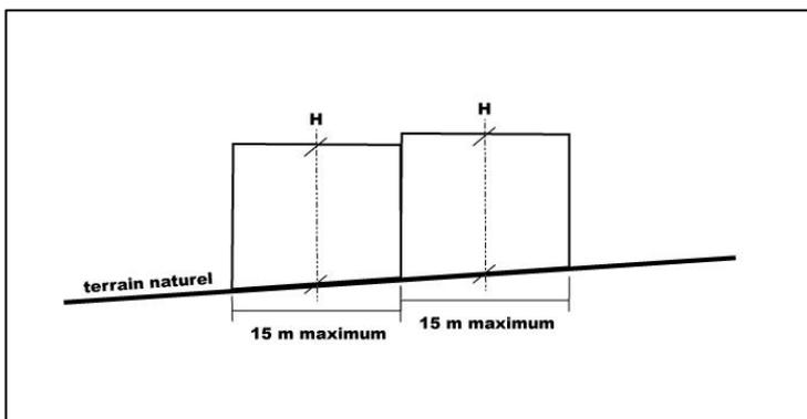
La hauteur\* maximale autorisée des constructions\* est une hauteur\* exprimée en mètre. Celle-ci repose sur les éléments suivants :
