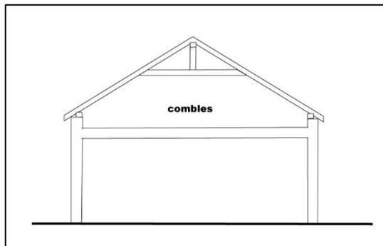
Superstructure d'un bâtiment\*, comprenant la charpente et sa couverture\* ; par extension\*, volume entre le plancher haut et la toiture d'un bâtiment\*.
