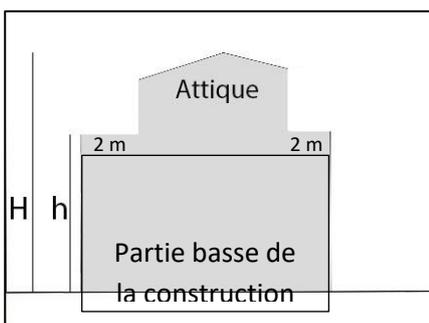
Étage supérieur d'un édifice construit en retrait par rapport au plan des façades\* de la partie basse de la construction.
