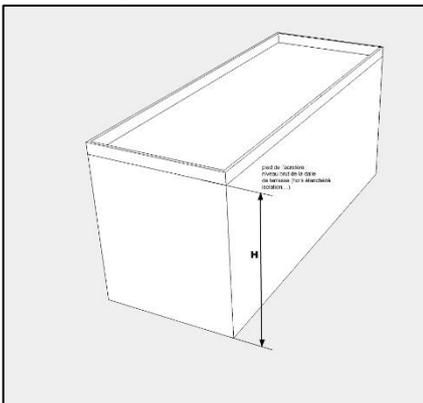
Élément d'une façade\* situé au-dessus du niveau\* d'une toiture-terrasse ou d'une toiture à faible pente pour en masquer la couverture\*. L'acrotère\* est souvent constitué d'un muret plein ou à claire-voie\* situé en bordure des toitures terrasses pour permettre le relevé d'étanchéité.
