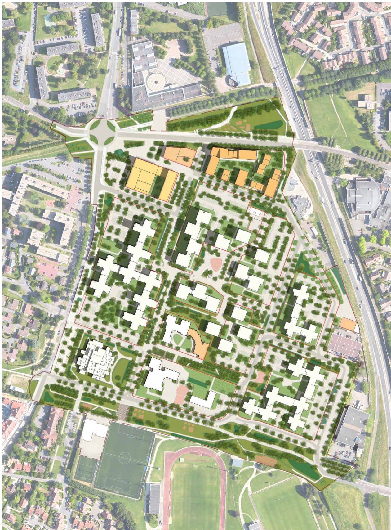
Plan-masse du projet mettant en évidence les réhabilitations des bâtiments existants (en blanc) et les nouvelles constructions (en orange) – source : D&A, pour la CA de Saint-Quentin-en-Yvelines
