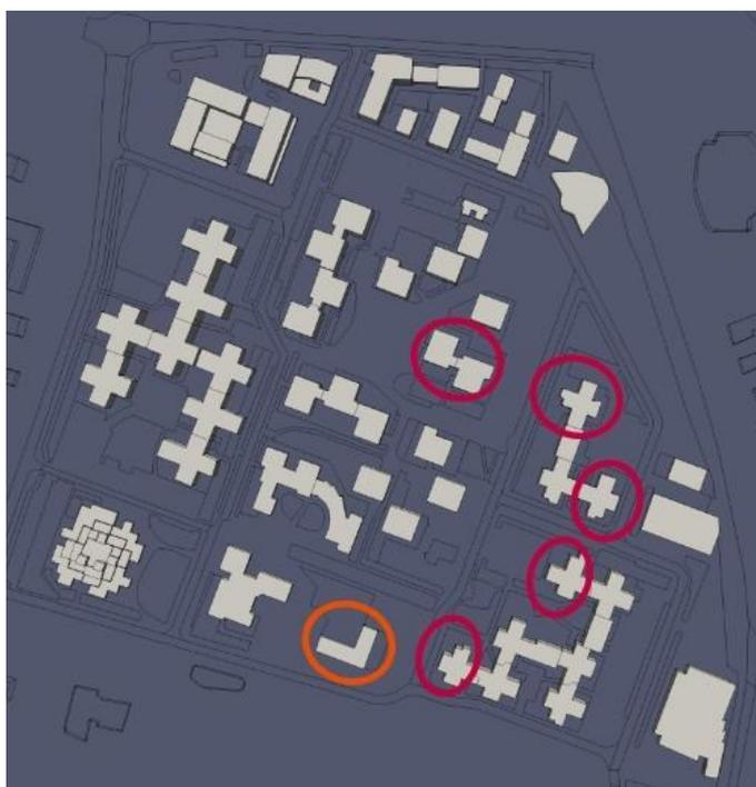
○ Bâtiments exposés aux vents : limiter les décrochements de façades (saillies des balcons, etc.) pour réduire les déperditions. Un espace tampon (loggias vitrées par ex.) sur les façades nord et est pourrait être envisagé (en neuf ou en rénovation).
