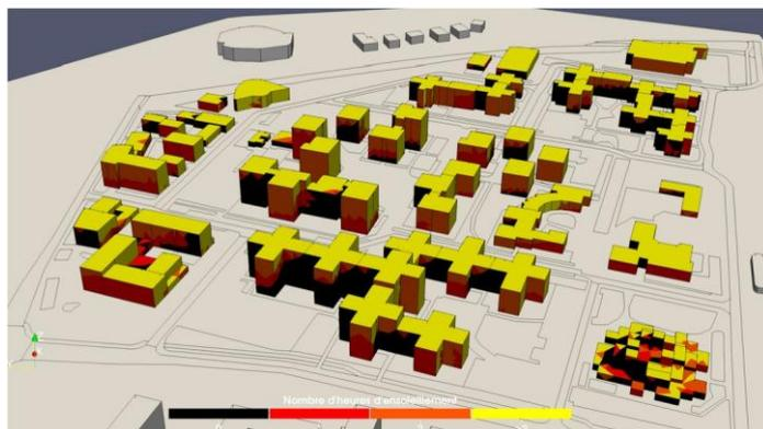
Figure 20 : Nombre d'heure d'ensoleillement reçu par les façades de bâtiments le 21 décembre (Vue des façades Ouest) état projeté
