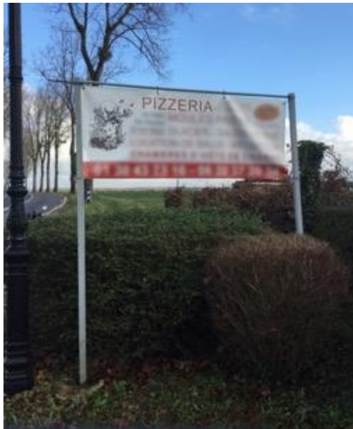
Enseigne scellée au sol implantée sur la limite séparative de propriété sans recul de la moitié de sa hauteur (non conforme), Magny-les-Hameaux, 2017
