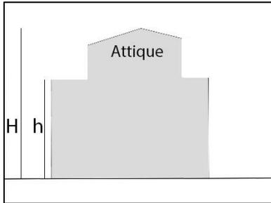
Étage supérieur d'un édifice construit en retrait\* par rapport au plan de la façade\*.
