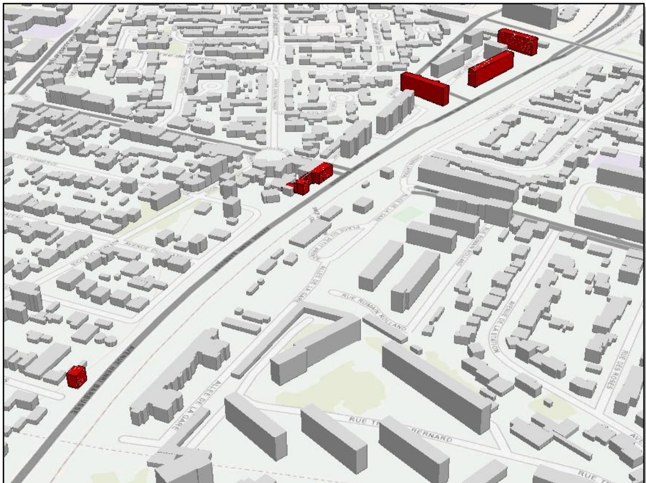
Carte 12 : Localisation des habitations en dépassement de seuil du bruit routier ( L_{den} ) et ferroviaire ( L_n ) (bâtiments en rouge) – Vue 3D – Vue de l’est
