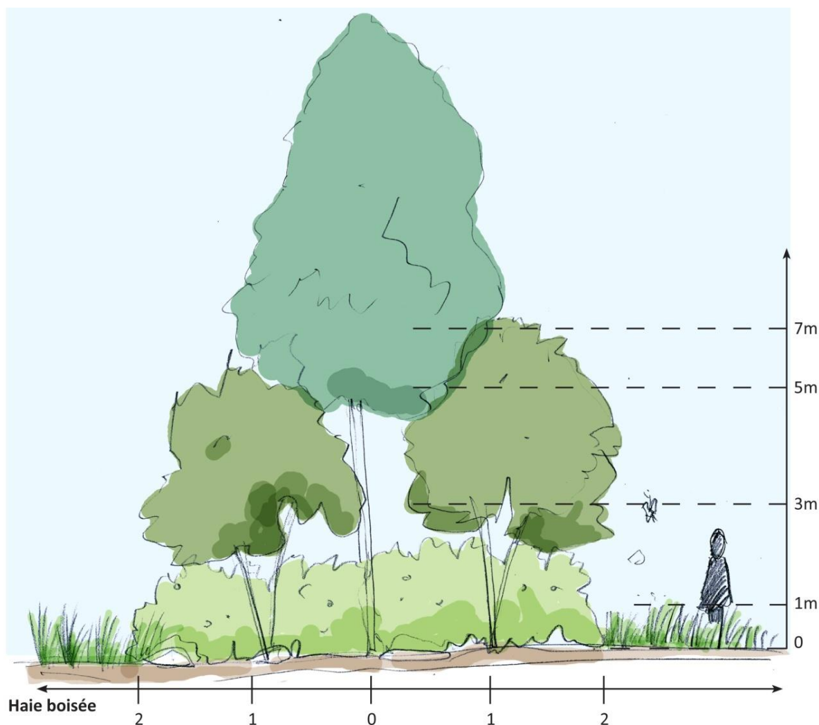
Figure 3 : principe d'aménagement des haies arborées larges
